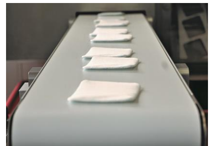
HydroClean®-Wundauflagen auf einem Förderband die Artus-Maschine verlassend. Quelle: Eigene Darstellung
