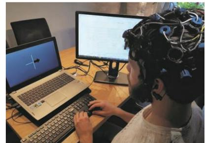
EEG-Messung mit dem OpenBCI Ultracortex Headset für die Kalibrierung des ErrP-BCIs.
