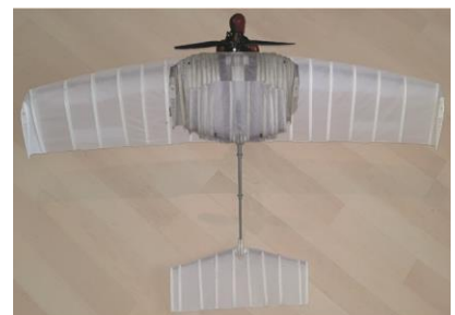
Der Flügel des IXIOS-Prototyps, von oben gesehen, zeigt die Einziehbarkeit der Struktur. Sein kompaktes System ermöglicht es, seine Spannweite von ca. 90 cm auf 24 cm zu verringern, sodass es nur noch 27 Prozent seiner gesamten Spannweite ausmacht.
