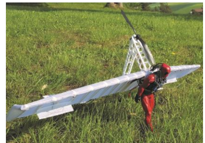
Projekt IXIOS, eine fliegende, einziehbare Struktur, die nach dem Prinzip der Leichtbauweise unter Verwendung der neuesten Materialtechnologien gebaut wurde, um Leistung, Kompaktheit und Sicherheit für ein vogelähnliches Ergebnis zu optimieren.
