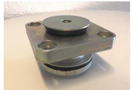
Kabinenlager eines Baggers
