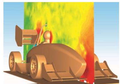
Druckvisualisierung mittels ProCap System von Streamwise. Dabei wird in Echtzeit gemessen und visualisiert.
