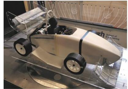
Das fertig montierte Modell im Windkanal des ZAV. Die RUAG Waage befindet sich im Innern der Hauptverschalung.
