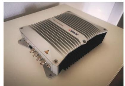
Die MicroAutoBox III von dSpace, das Steuergerät, welches im Fahrzeug verbaut wird
