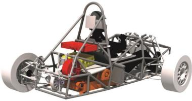
Heckansicht des Formula Student Rennwagens mit Hochspannungs-Akkumulator (orange), Inverter (gelb), High Voltage Control Box (rot) und Motor (rot)
