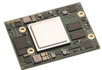
Der Zynq Ultrascale+ von Xilinx ist ein SoC (System on Chip) mit programmierbarer Logik und mehreren Prozessoren auf einem Chip.
