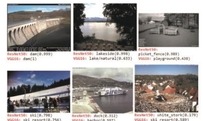
Auswahl von gut erkannten Objekten und Szenen inklusive Voraussagewahrscheinlichkeit mit TensorFlow anhand der Modelle ResNet50 und VGG16
