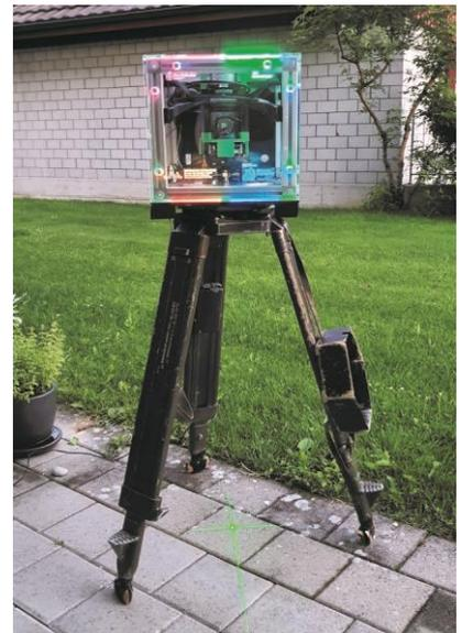
Der Northfinder wurde für den Schweizerischen Erdbebendienst entworfen, konstruiert und gebaut, das sichtbare Laserkreuz auf dem Boden markiert die Nordrichtung.
