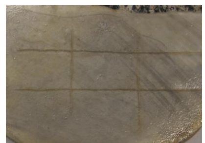
Korrosionstest nach 48 h Inkubation in einer Salzlösung.
