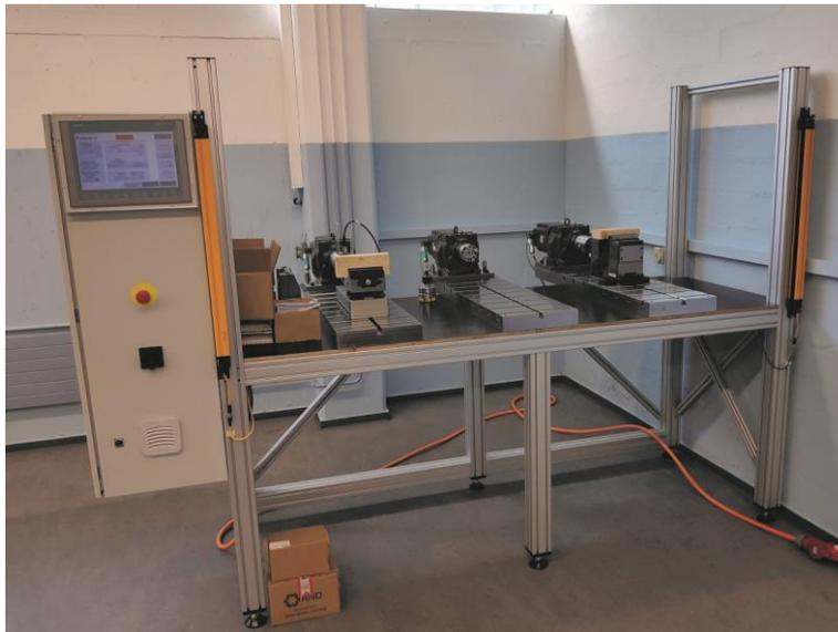
In der Abbildung links ist der fertige Prüfstand. Auf der linken Seite ist der Schaltschrank mit eingelassenem HMI zu sehen. Auf der Konstruktion sind die drei Prüfplätze aufgebaut. Diese bestehen jeweils aus einem Servomotor mit Getriebe, einer Grundplatte und einer Klauenkupplung. Auf zwei Prüfplätzen sind Spannmittel zum Testen aufgebaut. Für die Sicherheit der Maschine sorgt ein Lichtvorhang, links und rechts an der Konstruktion (gelbe Balken).
