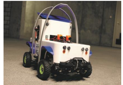
Das Bild zeigt den VR Racing Robot. Dieser weist ein stabiles und PW-ähnliches Fahrverhalten auf. Es sind die Kameras zu sehen, mit welchen sich der Fahrer orientieren kann. Die IR-Sensoren dienen zur Auslösung des Assistenzsystems.
