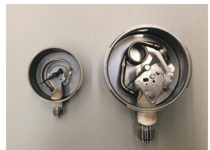
Mit der Anlage können die abgebildeten Rohrfeder-Manometer kalibriert und zertifiziert werden.
