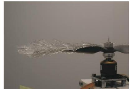
Beim normalen, unbearbeiteten APC-Propeller bildete sich während drei Minuten unter Vereisungsbedingungen eine Eisschicht entlang der Eintrittskante und an den Spitzen lange Eisnadeln.
