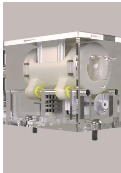
Linearantrieb Prototyp. Gehäuse zu Anschauungszwecken transparent. Dimensionen: B75xH85xL115 mm
