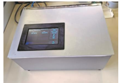
Gasanalysesystem mit Touchdisplay im Testbetrieb
