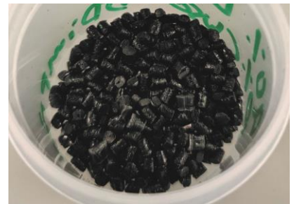
Das neuentwickelte Polymer aus Polyamid und rezykliertem, devulkanisiertem Reifenpulver
