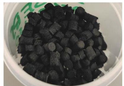
Das neuentwickelte Polymer aus SEBS und rezykliertem, devulkanisiertem Reifenpulver
