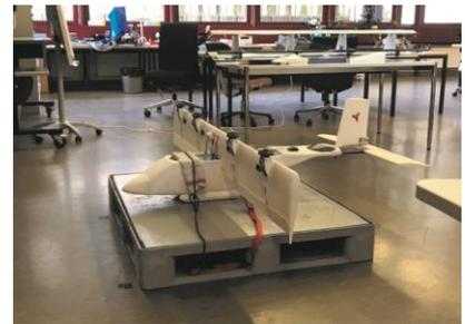
Bevor das Flugzeug geflogen werden konnte, mussten Bodentests durchgeführt werden. So wurden beispielsweise Stabilitäts- und die Batterietests (sichtbar im Bild) durchgeführt.
