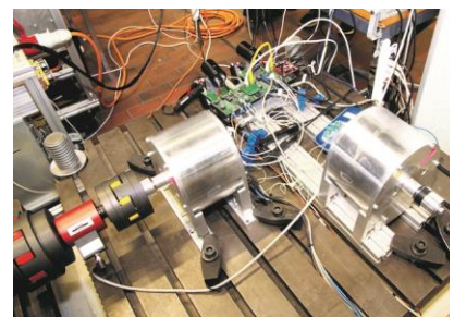
Das Bild zeigt den Motorenprüfstand mit der Messwelle links und dem zweiten Motor im Leerlauf rechts.
