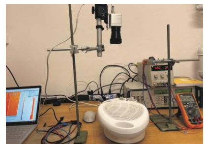
Versuchsaufbau des Experiments, um den Widerstand sowie die Temperatur des Heizdrahtes in der Luft zu messen.
