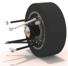
Radaufhängung mit integrierter Antriebseinheit.
