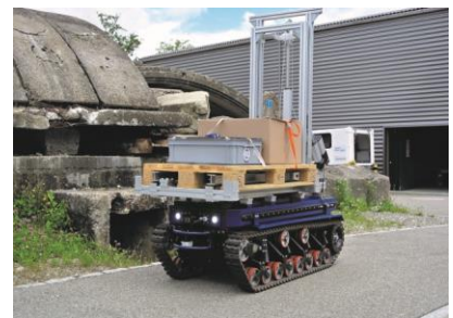
Palettentransporter fertig montiert auf dem UGV
