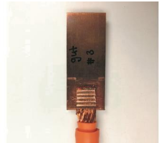
Kameraaufnahme des originalen Probestücks (ultraschallverschweisste Kupferlitze auf Kupferterminal)
