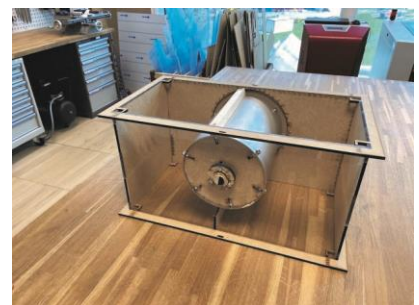
Funktionsmuster: Trommelmagnet der Funktion Metallabscheidung.
