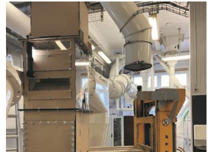
Funktionsmuster: Counter der Funktion Schwerteilabscheidung.
