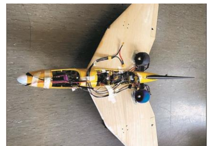
Das elektronische System und die Triebwerke sind funktionsfähig und im Flugzeug installiert.
