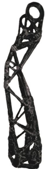
Am Ende des Entwicklungsprozesses resultierte eine Carbon-Fachwerkstruktur, welche die geforderten Lasten aufnehmen kann. Das Bauteil hat eine Masse von 107g. Das ursprüngliche Aluminiumbauteil hat eine Masse von 315g. Somit konnte die Masse um 66% reduziert werden.
