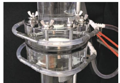
Abbildung 2: Entwickeltes Permeameter aus PMMA im Bereich der Probenaufnahme. Der Druckabfall über dem Filter wird über die Ringleitungen gemessen.
