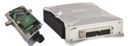
Selbst entwickelte Datenerfassungshardware und der verwendete Boardcomputer
