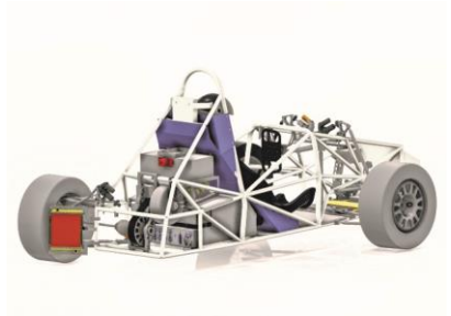
Heckansicht des Formula Student Rennwagen mit Blick auf die elektrischen Komponenten.
