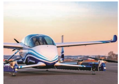
Auroras elektrisch angetriebener PAV kann bis zu zwei Personen mit einer Geschwindigkeit von 160 km/h befördern. Dabei kann eine Reichweite von 80 Kilometern erreicht werden.
