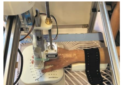
Während der Validierungsphase wurden Probandenversuche durchgeführt. Dieses Bild zeigt den Aison Pro, der den Handrücken (dorsal) einer Versuchsperson scannt. Ihre Hand liegt auf der Handpositionierung und wird durch diese fixiert.
