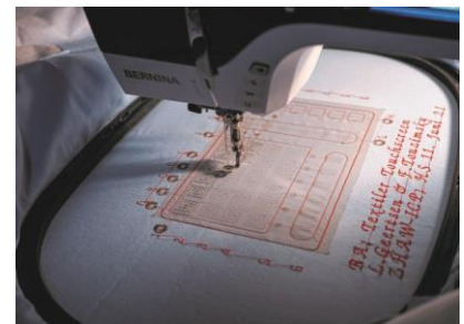
Die Stickmaschine näht die letzten Elektroden des oberen Sensorlayers auf ein resistives Textil.
