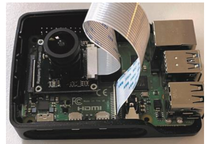
Raspberry Pi 4 Model B als Embedded Plattform mit installiertem Kameramodul.
