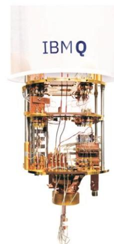
Ein aktueller IBMQ-Quantencomputer wie in der Arbeit verwendet wurde. Quantencomputer müssen fast auf den absoluten Nullpunkt gekühlt werden, damit Quantenbits nicht durch Störungen beeinflusst werden. (Bildquelle: IBM)
