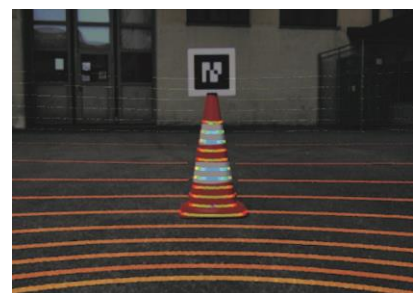
Überlagerung von LiDAR Punktwolke und Kamerabild
