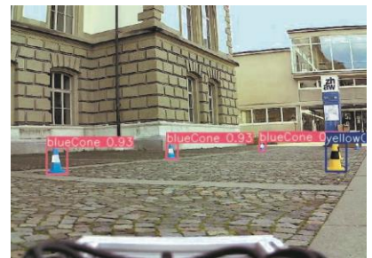
Leitkegelerkennung mit Neuronalem Netz auf einer Rennstrecke
