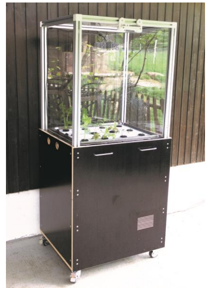
Abgebildet ist ein Prototyp eines intelligenten Gewächshauses für den urbanen Raum. Dieses wird vollkommen autark mit Solarenergie betrieben. Das Aeroponik-Bewässerungssystem besprüht die in der Luft hängenden Wurzeln der Pflanze in einem vorgegebenen Intervall. Zudem werden Sensordaten an eine Webseite gesendet, mit der der Benutzer interagieren und sein Gewächshaus steuern und überwachen kann.
