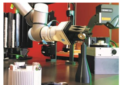
Maschinentisch der gebauten Magnetestmaschine mit verschiedenen Prüfstationen
