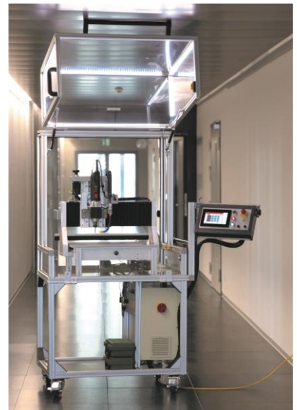
Die CNC-Maschine mit geöffneter Schutzhaube
