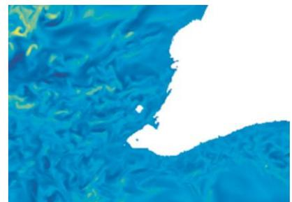
Dargestellt ist ein horizontaler Schnitt der simulierten Windgeschwindigkeit auf der Höhe des erneuerten Modells eines Hauses. Sichtbar sind die hohen Windgeschwindigkeiten (rot) und die tiefen (blau), sowie Strukturen (weiss).
