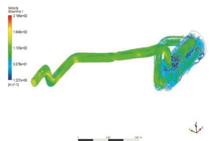
Strömungslinien durch die Gesamtabgasanlage
