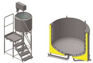
3D-Modell des gesamten Wärmetauschers mit Treppe und Rührwerk der Firma Kalt Maschinenbau AG (links), Querschnitt durch den Wärmetauscher ohne Rührpropeller (rechts)
