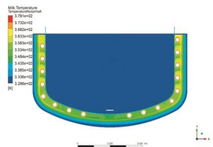
Temperaturen im Querschnitt nach 1200 Sekunden Simulationszeit
