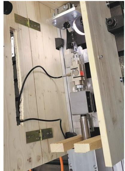
Testen der Messdatenerfassung mithilfe eines Uniaxialen Zugversuchs am Funktionsmuster
