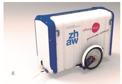
Darstellung des Anhängers mit vollständigem Aufbau und seitlichen Schieberverdecken.
