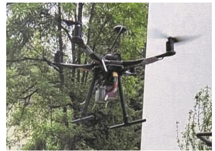
Ein Bild des Holybro s500 Quadcopters, der dem z-Achsen-Körpergeschwindigkeitsbezug von 0 m/s folgt, was zu einem Schwebeflugverhalten führt.
