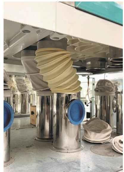
Derzeit eingesetzter Auslaufschlauch (hinten) und entwickelter Prototyp (vorne) im ausgelenkten Zustand
