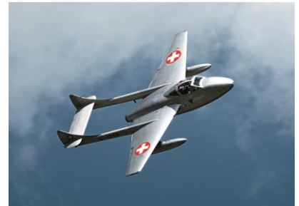
Ein DH.115 Vampire Trainer der von der Jet and Prop Heritage GmbH für das FFA Museum in Altenrhein flugtauglich gehalten wird. Charakteristisch sind der Gabelschwanz und die seitliche Sitzanordnung der Piloten.
