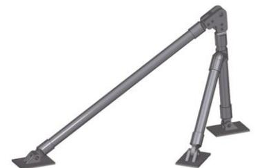
Eines der drei erarbeiteten Konzepte, bestehend aus Zug- und Druckrohren. Damit wird eine Reduktion der Masse von 40% erreicht.
