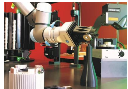
Maschinentisch der gebauten Magnetestmaschine mit verschiedenen Prüfstationen
