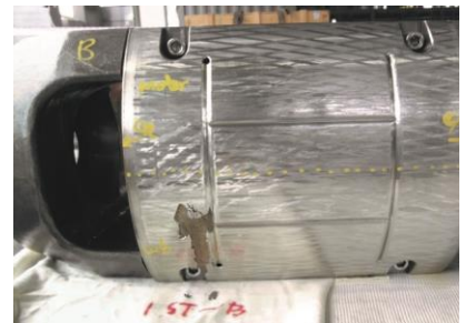
Beschädigter Kreuzkopf mit klar ersichtlicher Delamination der Weissmetallschicht
